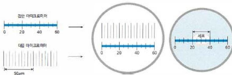
$$\text{• 접안 마이크로미터 한 눈금의 길이} = \frac{(\text{대물}) \text{ 마이크로미터 눈금수}}{(\text{접안}) \text{ 마이크로미터 눈금수}} \times 10\mu\text{m}$$
